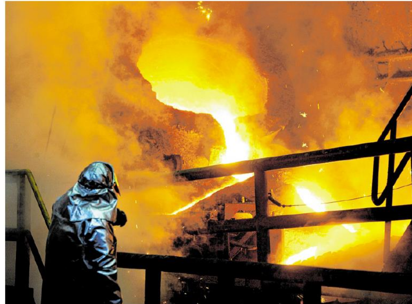
Flüssiges Eisen wird am Hochofen von DK Recycling und Roheisen in Hochfeld abgossen. Verwertet werden dort Reststoffe aus der Stahlindustrie.
