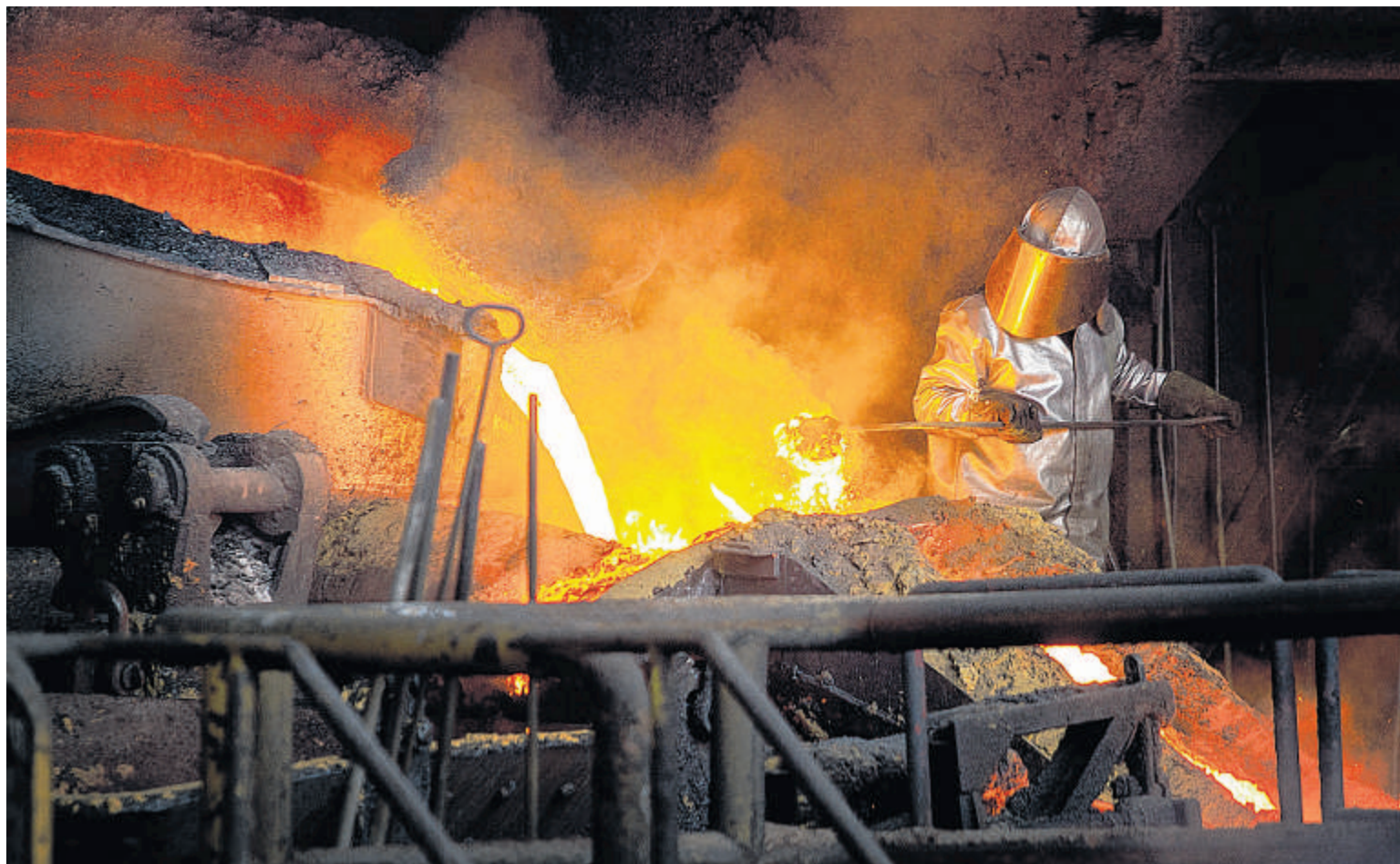
Eine heißer Job: Nur in hitzefester Schutzkleidung kann in der Nähe des flüssigen Eisens gearbeitet werden.
