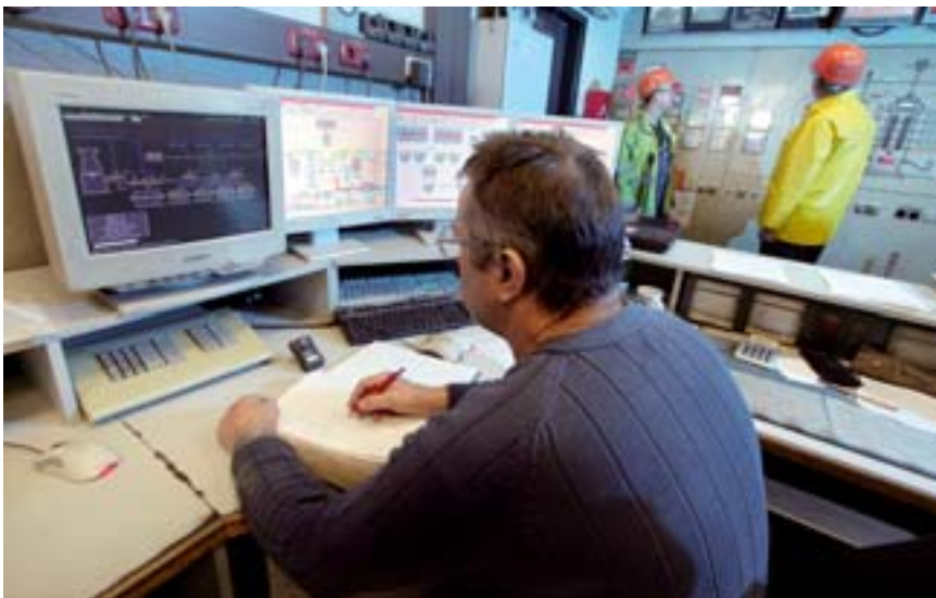
Die Produktion von Roheisen aus Reststoffen wird bei der Firma DK sehr genau überwacht. In der Messwarte wird die Produktion der Schmelze im Hochofen kontrolliert.
